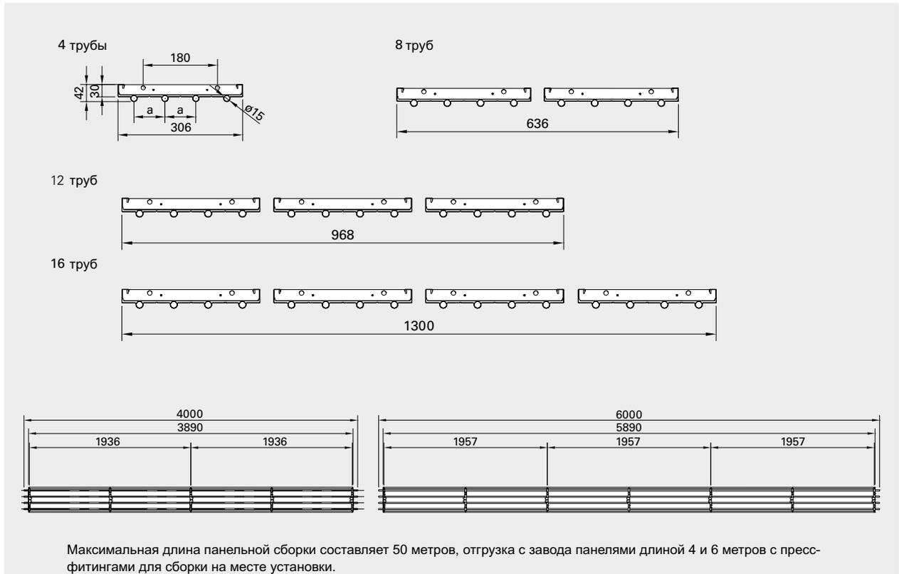
Возможные схемы соединения панелей
