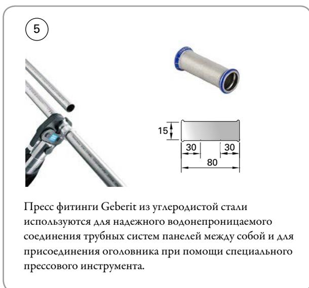
Пресс фитинги Geberit из углеродистой стали используются для надежного водонепроницаемого соединения трубных систем панелей между собой и для присоединения оголовника при помощи специального прессового инструмента.
