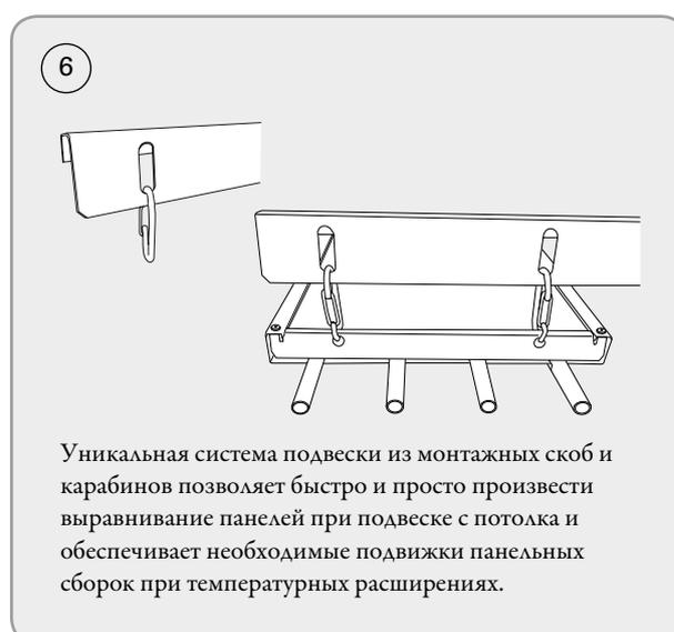
Уникальная система подвески из монтажных скоб и карабинов позволяет быстро и просто произвести выравнивание панелей при подвеске с потолка и обеспечивает необходимые подвижки панельных сборок при температурных расширениях.
