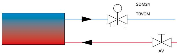
**SDM24, пропорциональный электропривод 24В~**
